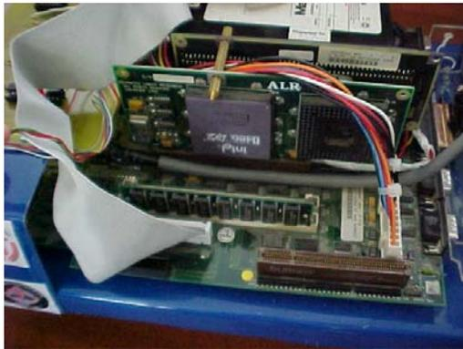
Figura 4 – Pormenor da motherboard incluindo o processador
