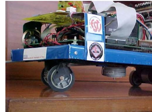
Figura 2 – Pormenor do motor de passo que faz virar as rodas dianteiras
